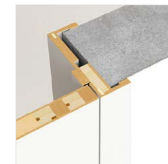
Короб компланарный, толщина полотна 39 мм
